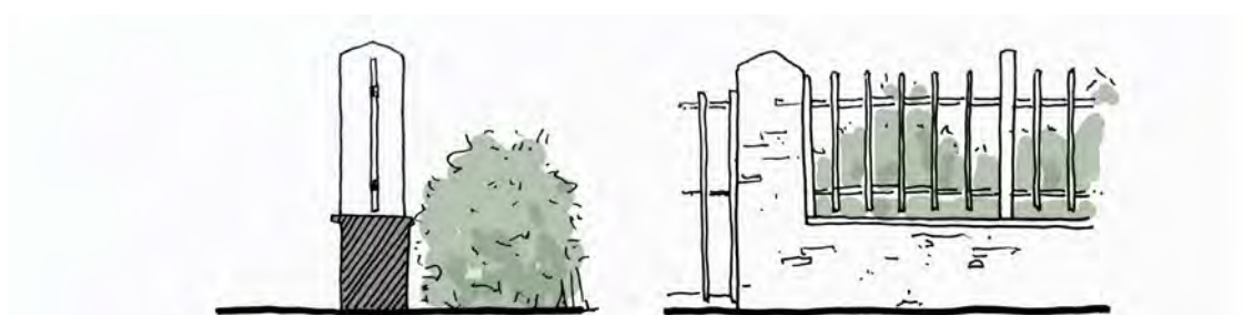
Mur bahut (proportion à définir en fonction de la hauteur de la grille, qui devra toujours être plus importante que la hauteur du soubassement maçonné)
