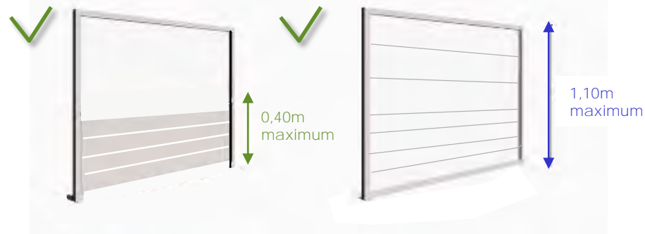
^ Exemple garde-corps en bois plein en partie basse
